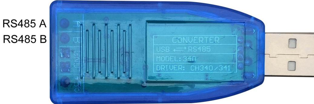
当 BMS 连接电池组后，将 RS485 线缆连接到转换模块上面。
